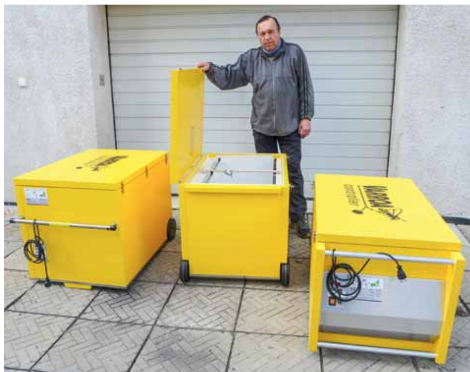
Ing. František Rudý při převímce termoboxů k ošetření plástů se zavíčkovaným plodem k léčení varroáze bez chemie
